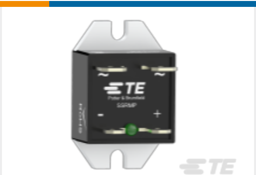
TE Part # 2323802-4 SSRMP-480D25 = Mini Puck,25A,480V AC
