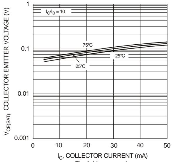
Fig. 2 V<sub>CE(SAT)</sub> vs. I<sub>C</sub>
