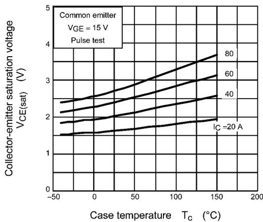
**Fig. 8.5  $V_{CE(sat)} - T_C$**
