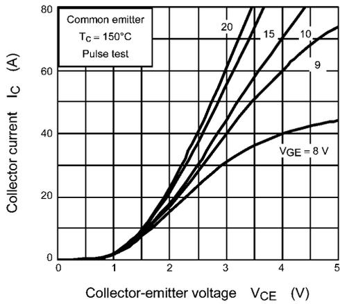
**Fig. 8.3  $I_C - V_{CE}$**
