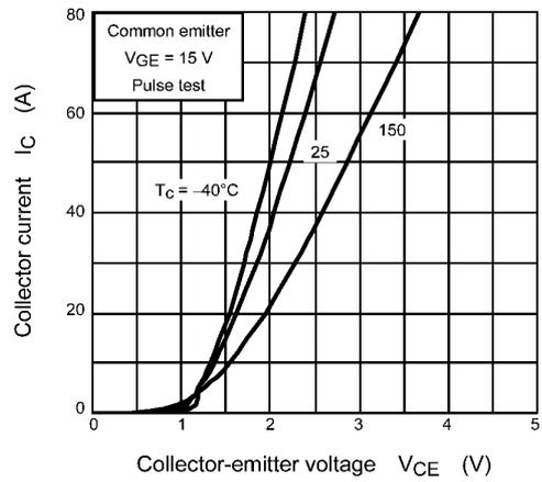
**Fig. 8.4  $I_C - V_{CE}$**
