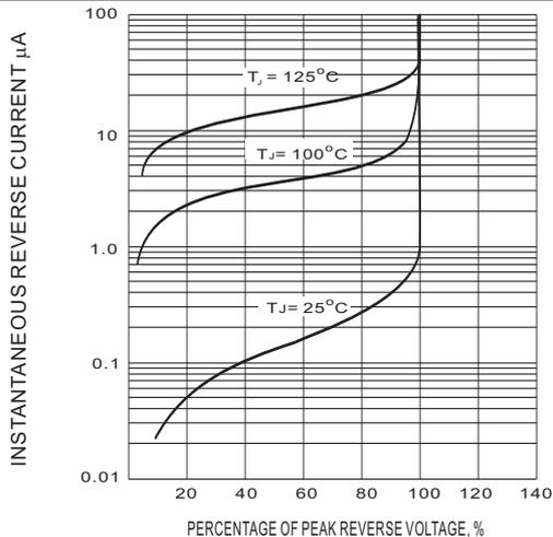
Fig. 5-TYPICAL REVERSE CHARACTERISTIC
