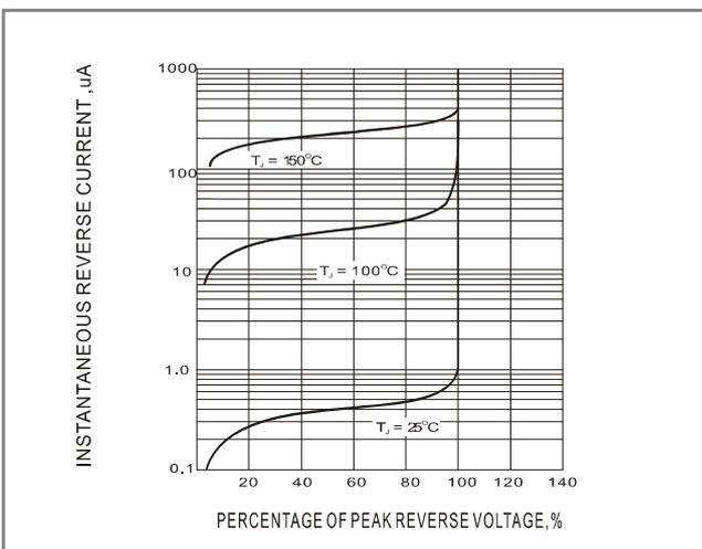
Fig.5-TYPICAL REVERSE CHARACTERISTIC
