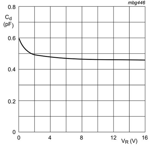
$f = 1\text{ MHz}; T_{amb} = 25\text{ °C}$
