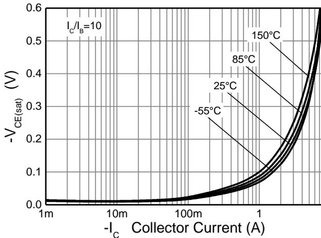
**Figure 8.  $V_{CE(sat)} \text{ v } I_C$**
