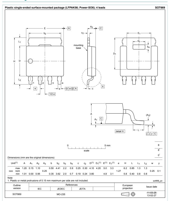
Fig. 14. Package outline LFPAK56; Power-SO8 (SOT669)
