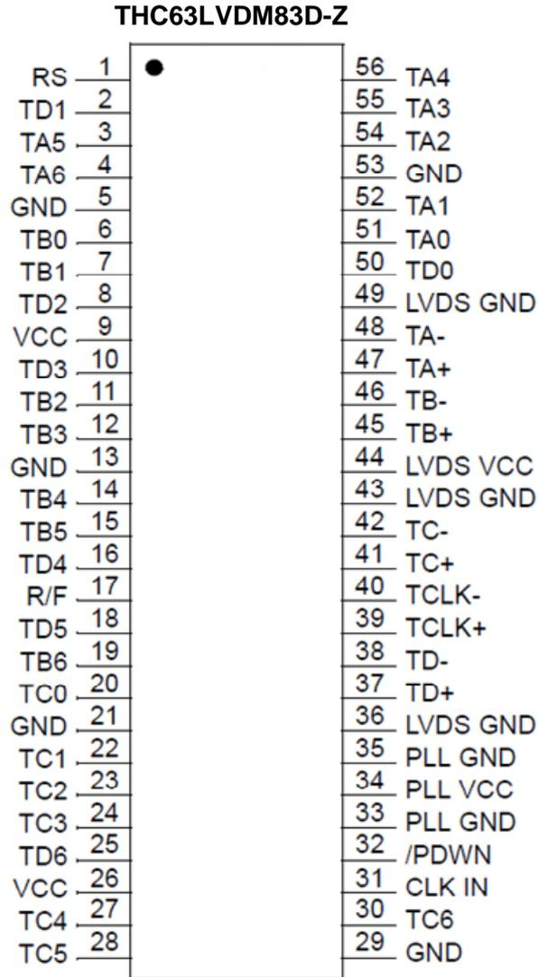
**Figure 2. Pin Diagram**
