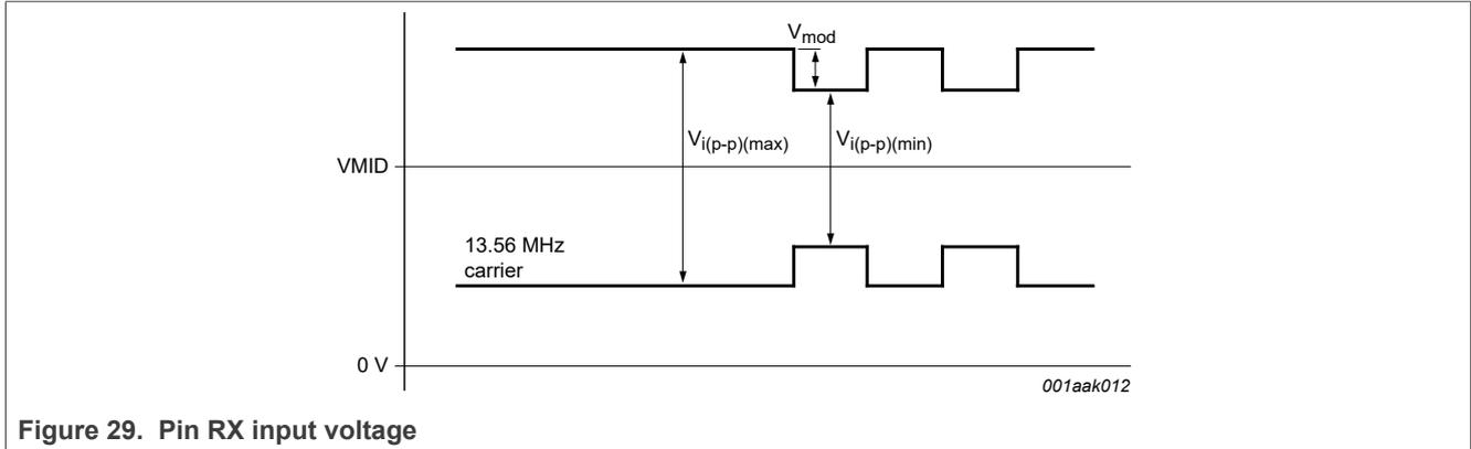
Figure 29. Pin RX input voltage
