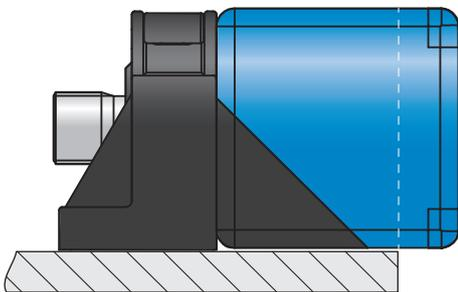
将设备安装在金属上时，有源头的建议超出部分：约 10 mm
