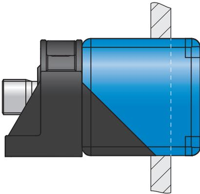
将设备安装在金属中时，有源头的建议超出部分：约 10 mm（非齐平式安装）
