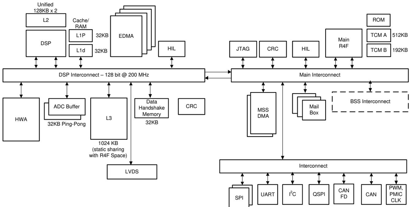
**Figure 7-4. Processor Subsystem**
