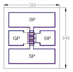
Chip dimensions : 310 X 340 microns Gate pad(GP) : 85 X 85 microns Drain pad(DP) : 85 X 85 microns Source pad(SP) : 260 X 85 microns Chip thickness : 100 microns
