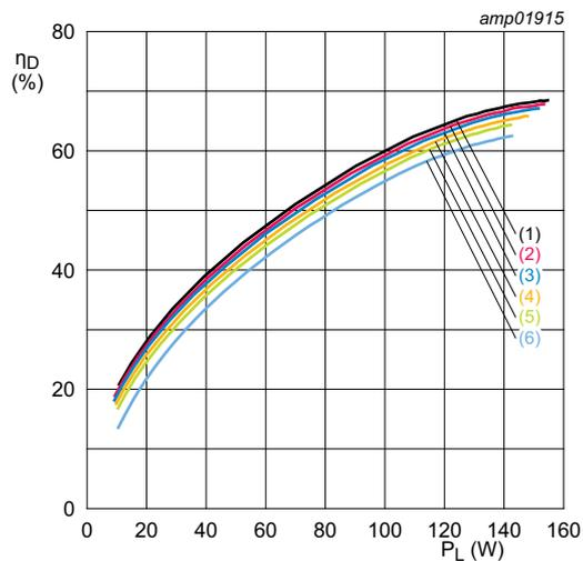
$V_{DS} = 32\text{ V}$ ;  $f = 860\text{ MHz}$ ;  $t_p = 100\text{ }\mu\text{s}$ ;  $\delta = 20\text{ }\%$ .
