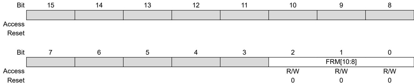
**Bits 2:0 – FRM[10:8]** Data Frame Counter bits
