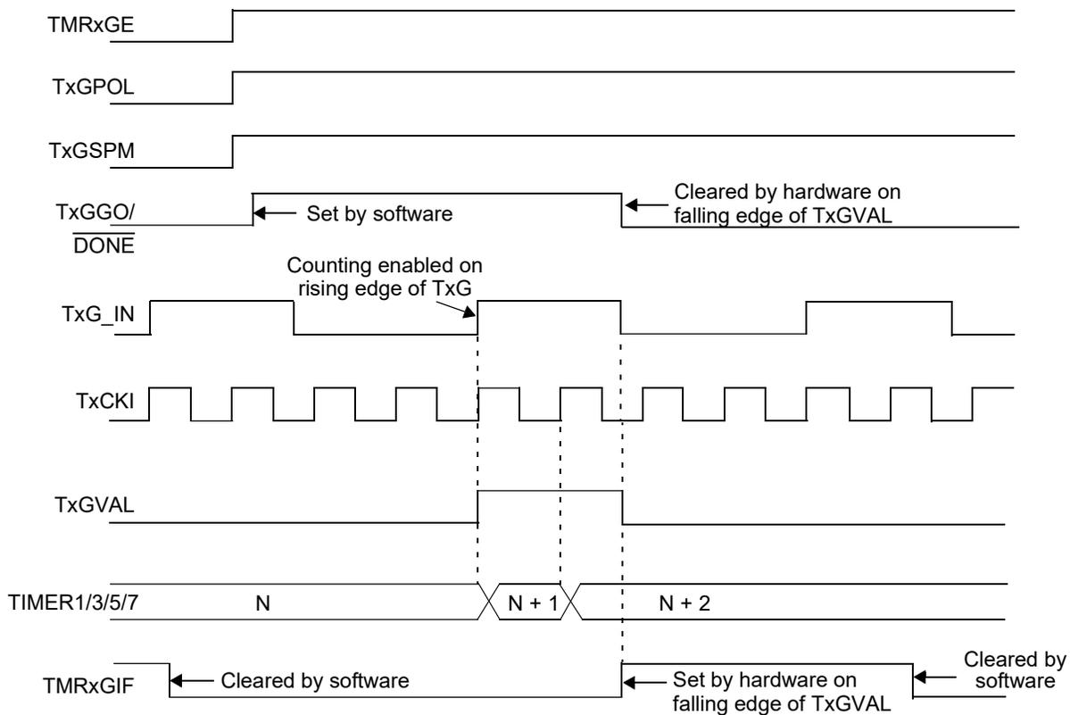
Figure 19-7. TIMER1 GATE SINGLE PULSE AND TOGGLE COMBINED MODE
