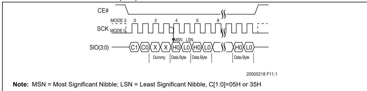
**FIGURE 5-29: READ-STATUS-REGISTER AND READ-CONFIGURATION REGISTER SEQUENCE (SPI)**
