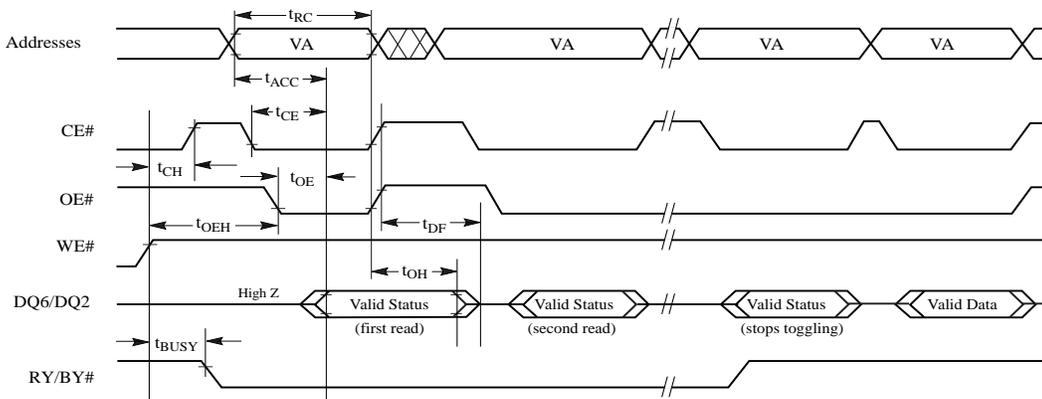
**Figure 20. DQ2 vs. DQ6 for Erase and Erase Suspend Operations<sup>[75]</sup>**
