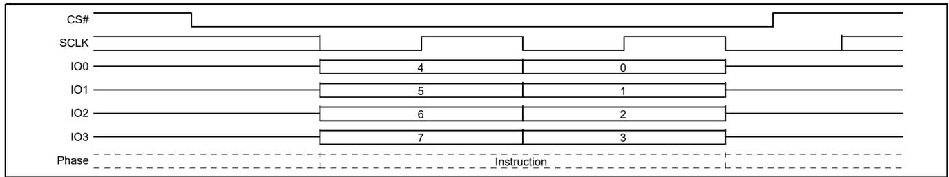
**Figure 56** Enter 4 Byte Address QPI mode
