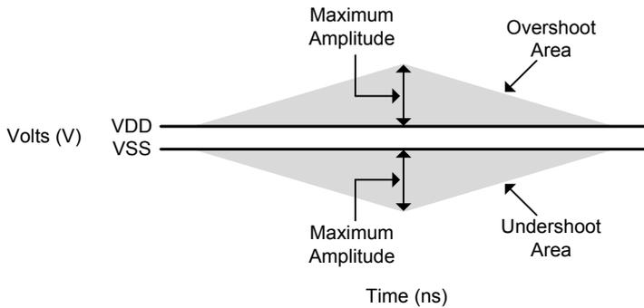
**Table 22. AC overshoot/undershoot specification for clock, data, strobe, and mask pins (DQ, UDQS, LDQS, UDQS#, LDQS#, DM, CK, CK#)**
