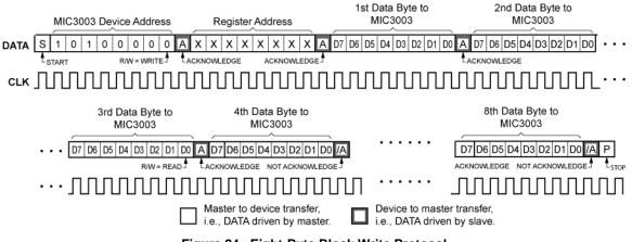
Figure 24. Eight-Byte Block Write Protocol
