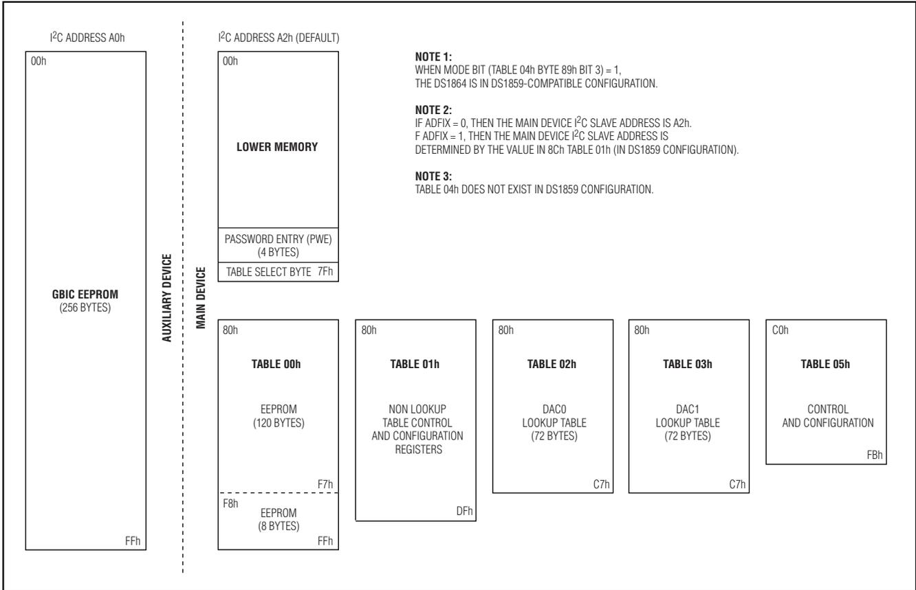
Figure 17. DS1859-Compatible Configuration (Mode Bit = 1)
