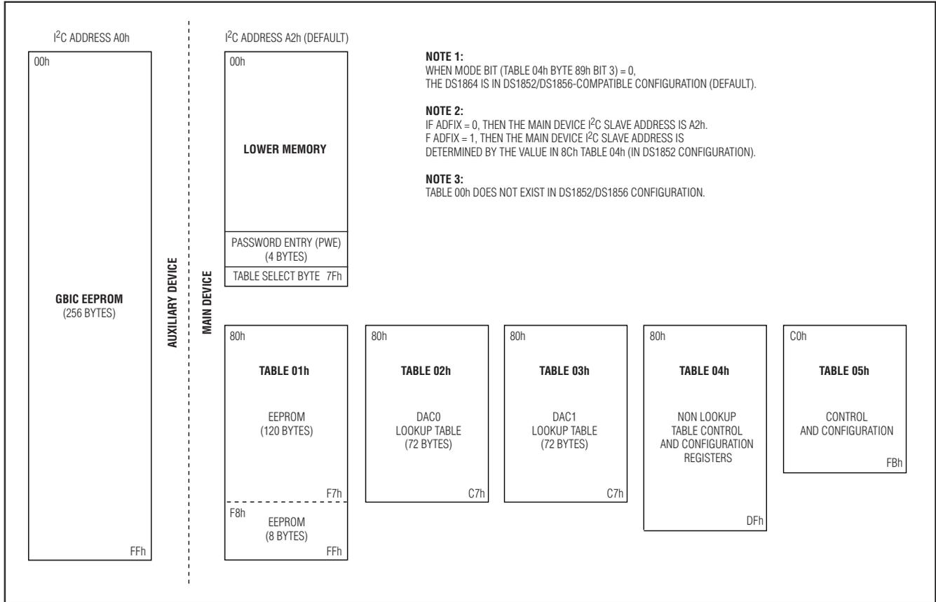
Figure 16. DS1852/DS1856-Compatible Configuration (Mode Bit = 0, Default)
