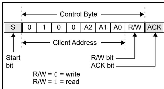
**FIGURE 1-6:** I<sup>2</sup>C™ Control Byte Format.
