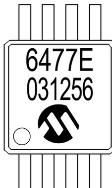
14-Lead SOIC (MCP6479)
