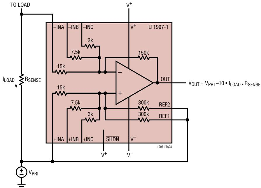
THIS CONFIGURATION SCALES THE INPUT. THE OUTPUT SIGNAL IS REFERENCED TO THE SAME GROUND DOMAIN AS THE INPUT. THUS THE CIRCUIT CAN OPERATE AS A LOW SIDE CURRENT SENSE IN THE PRIMARY DOMAIN. RELATIVE TO THE INPUT GROUND DOMAIN, THE OUTPUT CAN BE TRULY DRIVEN TO "ZERO".
