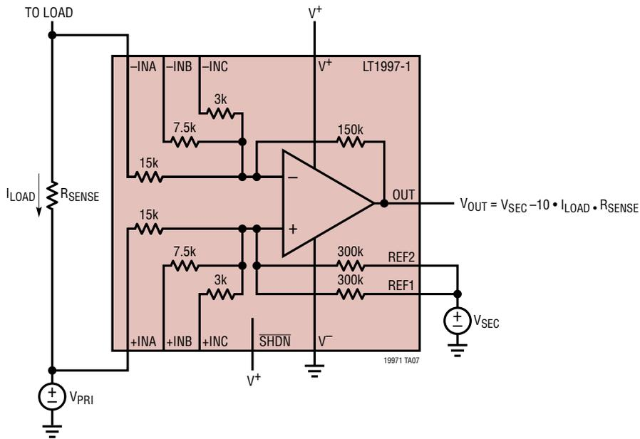
THIS CONFIGURATION SHOWS SCALING AND GROUND DOMAIN SHIFTING FROM  $V_{PRI}$  TO  $V_{SEC}$ .  $V_{SEC}$  CAN, OF COURSE, BE GROUND.
