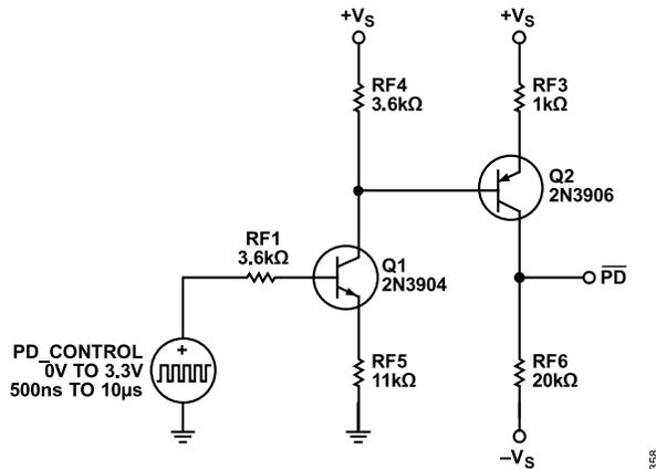
**Figure 57. Power-Down Circuit**
