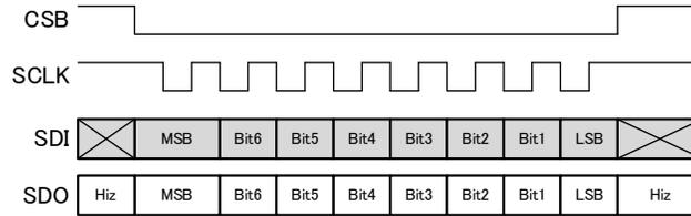
Fig. 12 SPI Waveform
