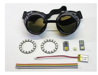
The kit version includes our costume goggles (http://adafru.it/1577), two NeoPixel rings (http://adafru.it/1463), a Trinket M0 (https://adafru.it/Agg) or Trinket Mini Microcontroller (http://adafru.it/1501), JST connector (http://adafru.it/1769), rechargeable 150 mAh LiPoly battery (http://adafru.it/1317), enough wire for all the connections, plus a USB battery charger (http://adafru.it/1304).
