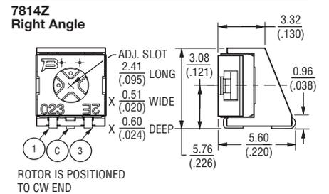
ROTOR IS POSITIONED TO CW END
