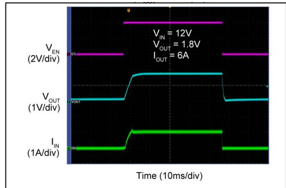
**FIGURE 2-38:** Inrush ( $C_{OUT} = 3000\ \mu\text{F}$ ).
