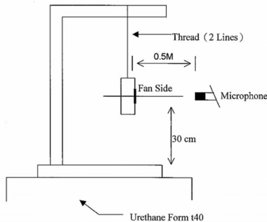
0.5 METER FROM MICROPHONE TO FAN INTAKE
