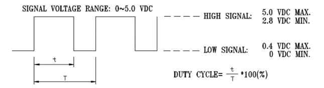
\*THE PREFERRED OPERATING FREQUENCY OF PWM SIGNAL IS 25K Hz. \*AT 100% DUTY CYCLE, THE ROTOR WILL SPIN AT MAXIMUM SPEED. \*AT 0% DUTY CYCLE, THE ROTOR WILL STOP SPIN. \*WHEN THE PWM CONTROL LEAD WIRE IS DISCONNECTED, THE ROTOR WILL SPIN AT MAXIMUM SPEED.
