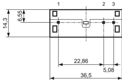
Tolerances grid distance  $\pm 0,2\text{mm}$
