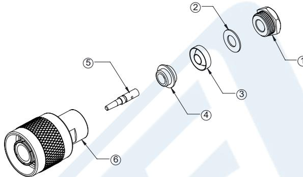
1. SLIDE CLAMP NUT (1), WASHER (2) & GASKET (3) OVER CABLE. STRIP CABLE AS SHOWN. DO NOT NICK BRAID WHILE CUTTING JACKET. TAPER END OF BRAID TO PERMIT ASSEMBLY OF CLAMP.
