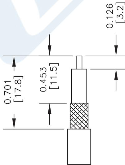
2. ADD EXTENSION (2) BY SLIDING EXTENSION BETWEEN BRAID & DIELECTRIC. SLIDE FERRULE OVER BRAID & CRIMP.
