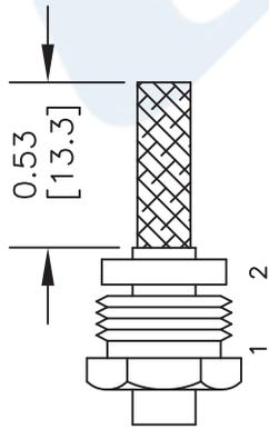
2. FORM BRAID OVER CLAMP NUT (3). TRIM BRAID BACK TO SHOULDER. CUT DIELECTRIC TO DIMENSION SHOWN. DO NOT NICK CENTER CONDUCTOR. SOLDER CONTACT TO CENTER CONDUCTOR. REMOVE EXCESS SOLDER. DO NOT OVER HEAT DIELECTRIC. INSERT CABLE ASSEMBLY INTO BODY & TIGHTEN.
