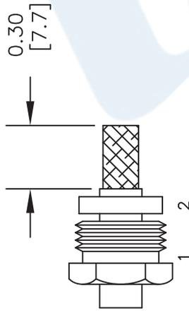
2. FORM BRAID OVER CLAMP NUT (3). TRIM BRAID BACK TO SHOULDER. CUT DIELECTRIC TO DIMENSION SHOWN. DO NOT NICK CENTER CONDUCTOR. SOLDER CONTACT TO CENTER CONDUCTOR. REMOVE EXCESS SOLDER. DO NOT OVER HEAT DIELECTRIC. INSERT CABLE ASSEMBLY INTO BODY & TIGHTEN.
