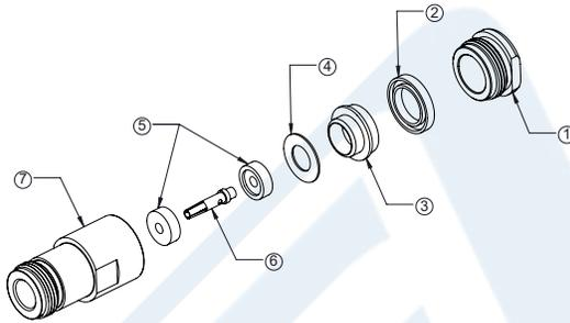
1. SLIDE CLAMP NUT (1) AND GASKET (2) OVER CABLE. STRIP CABLE AS SHOWN. DO NOT NICK BRAID WHILE CUTTING JACKET. TAPER END OF BRAID TO PERMIT ASSEMBLY OF CLAMP.
