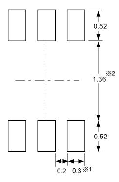
%1. ランドパターンの幅に注意してください (0.25 mm min. / 0.30 mm typ.)。 %2. パッケージ中央にランドパターンを広げないでください (1.30 mm ~ 1.40 mm)。
