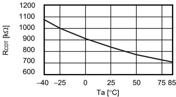
**3.4  $V_{CDT}$  vs  $T_a$  ( $V_{DS} = 15.5 V$ )**
