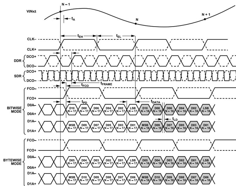
Figure 3. 12-Bit DDR/SDR, Two-Lane, 1x Frame Mode
