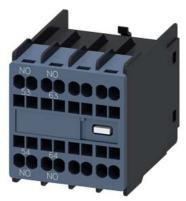
auxiliary switch, on the front, 2 NO, 53/54, 63/64, --/--, --/--, current path: 1 NO, 1 NO, --, --, spring-loaded terminal, for contactors 3RT2 and contactor relays 3RH2
