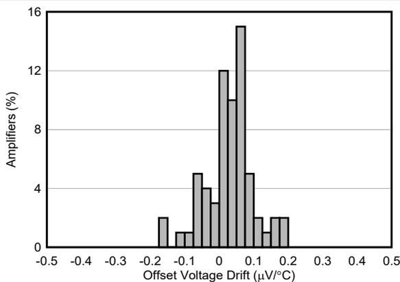
**Figure 5-5. Offset Voltage Drift Production Distribution**
