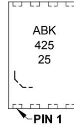
8-Lead DFN (3x3x0.9 mm) (MCP632)
