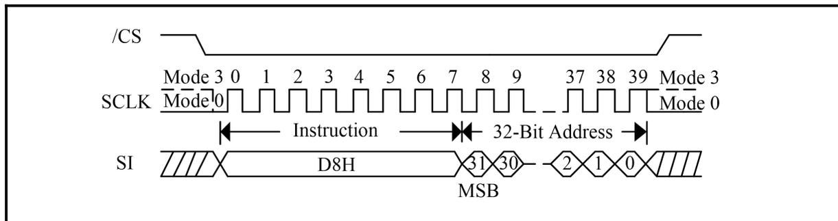
**Figure 153. 64KB Block Erase Sequence Diagram (QPI Mode/3-Byte Address Mode)**
