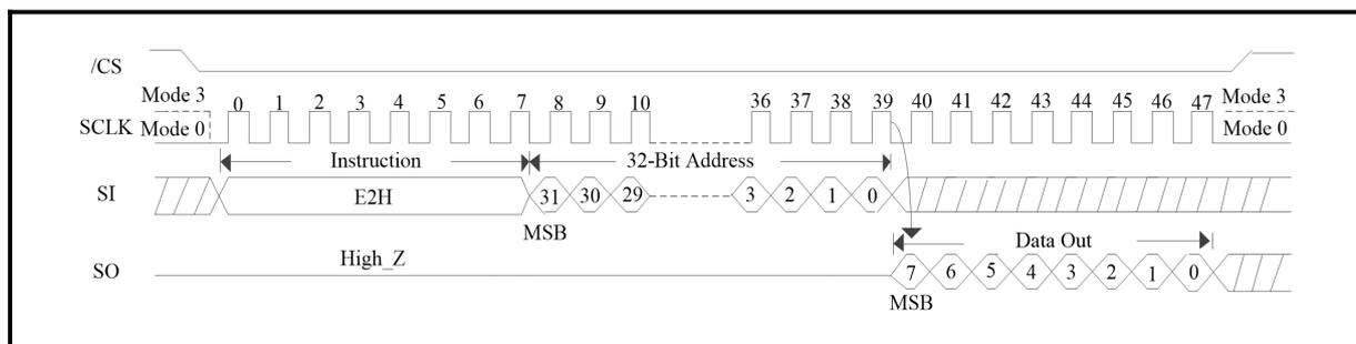
**Figure 173. Read SPB Status (QPI Mode/3-Byte Address Mode)**
